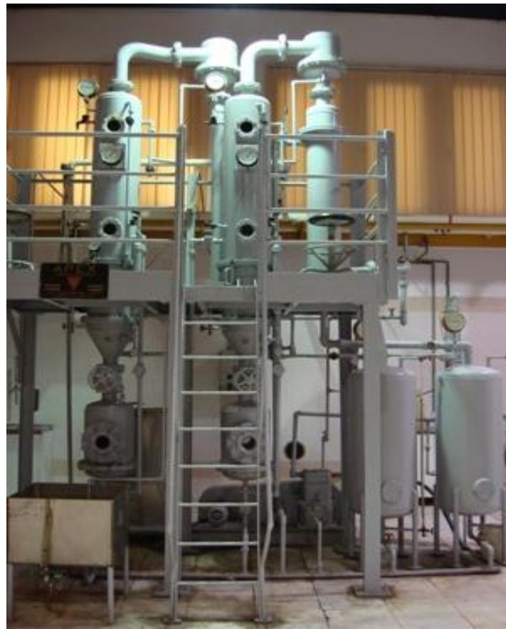
در عمل تبخیر کردن معمولاً هدف بدست آوردن ماده‌ای با غلظت بیشتر و یا حتی کریستال ماده غلیظ شونده می‌باشد ولی در مواردی نیز منظور بدست آوردن ماده رقیق‌تر و حتی خالص می‌باشد که می‌توان به عنوان مثال تغليظ شربت شکر و بدست آوردن کریستال‌های شکر و یا تبخیر آب دریا و کندانس کردن بخارات حاصله به صورت آب شرب را نام برد.
